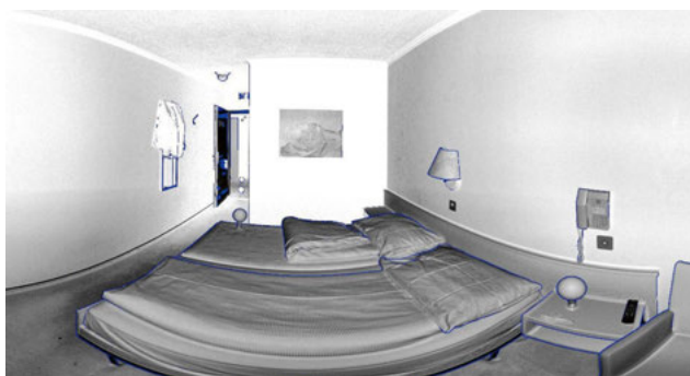
Laserscan eines Hotelzimmers mit extrahierten Linien. (Bild: GeoZ)
