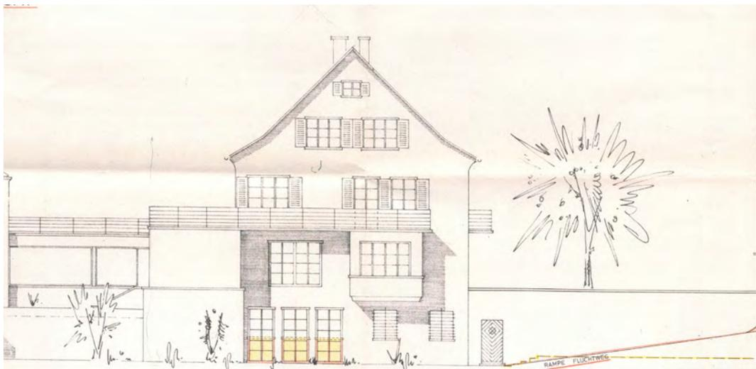
Abb. 11: Der Archivplan mit der Ansicht von Osten zeigt, dass das Untergeschoss des Hauptgebäudes sowie die bestehenden Stützmauern nördlich und südlich davon aufgrund der steil abfallenden ostseitigen Hangkante vollständig sichtbar sind (Plan von 1929 resp. Umbau von 1990 in rot/gelb).
