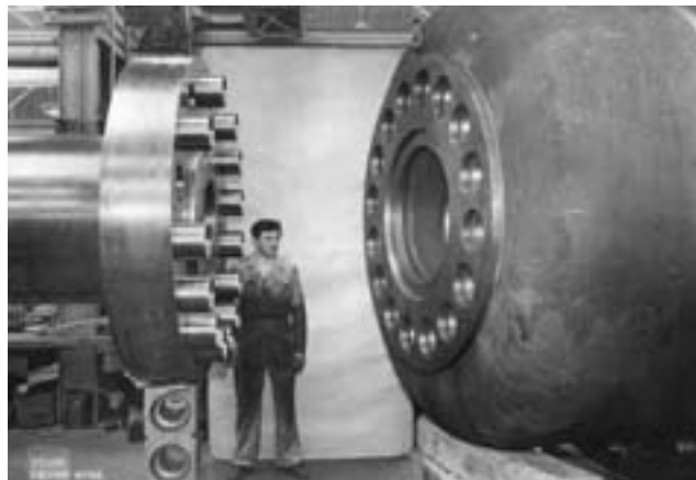
Aus dem Bildarchiv der Firma Escher Wyss: Welle mit Ring und Servomotorgehäuse für das Wasserkraftwerk in Assuan (Ägypten). (Bild: Stadtarchiv)
