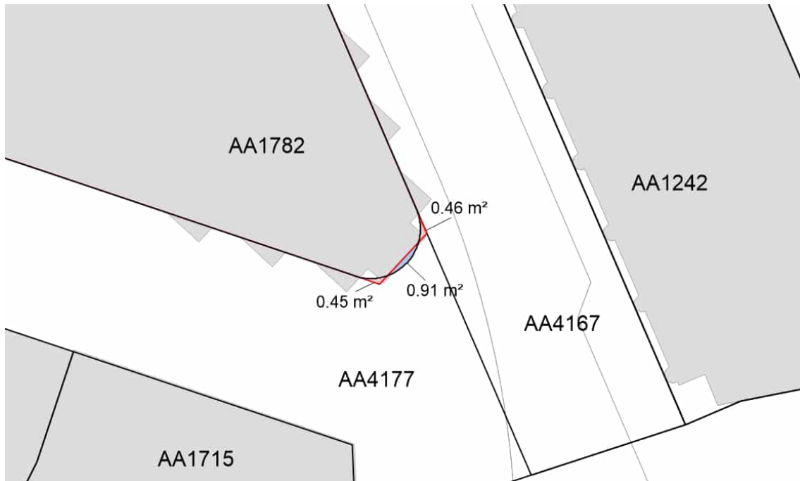
Abbildung 14: Detailausschnitt Änderung Parzellengeometrie und Abtauschflächen Rot: Tauschfläche AA4177 (Stadt) an AA1782, blau: Tauschfläche AA1782 an AA4177 (Stadt)
