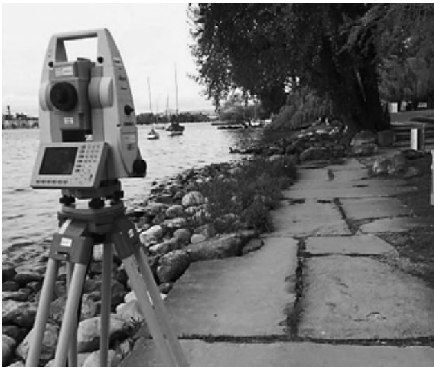
Periodische Nachführung Gewässer: Vermessung der Seeuferlinie. (Bild: GeoZ)
