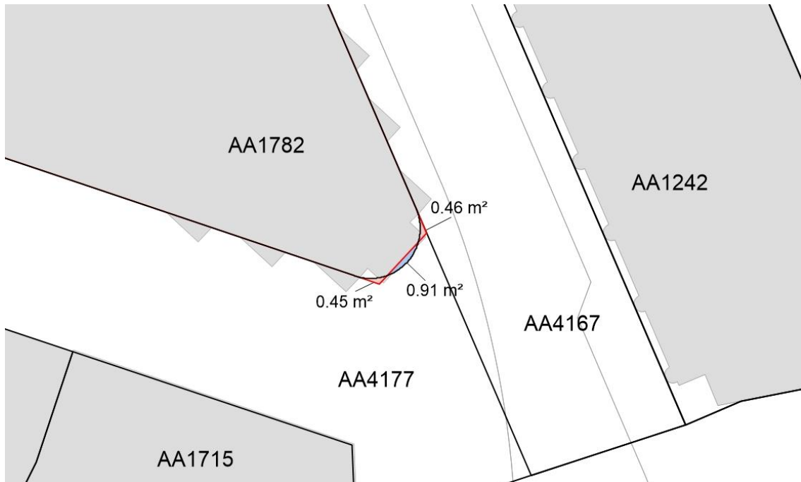
Abbildung 15: Detailausschnitt Änderung Parzellengeometrie und Abtauschflächen Rot: Tauschfläche AA4177 (Stadt) an AA1782, blau: Tauschfläche AA1782 an AA4177 (Stadt)
