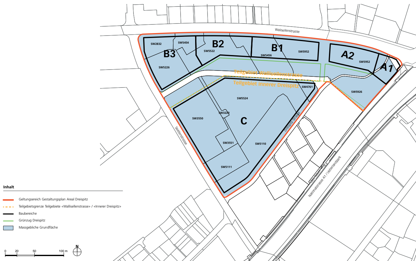
Abb. 30: Bezugsflächen für die massgebliche Grundflächen zur Berechnung der zulässigen Ausnützung
