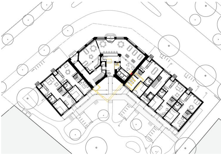
Projekt «LENA», Grundriss Erdgeschoss mit hofseitiger Laubengerschliessung; prominente Ecklage des Altbaus, der seitlich mit zwei Ergänzungsbauten erweitert wird.
