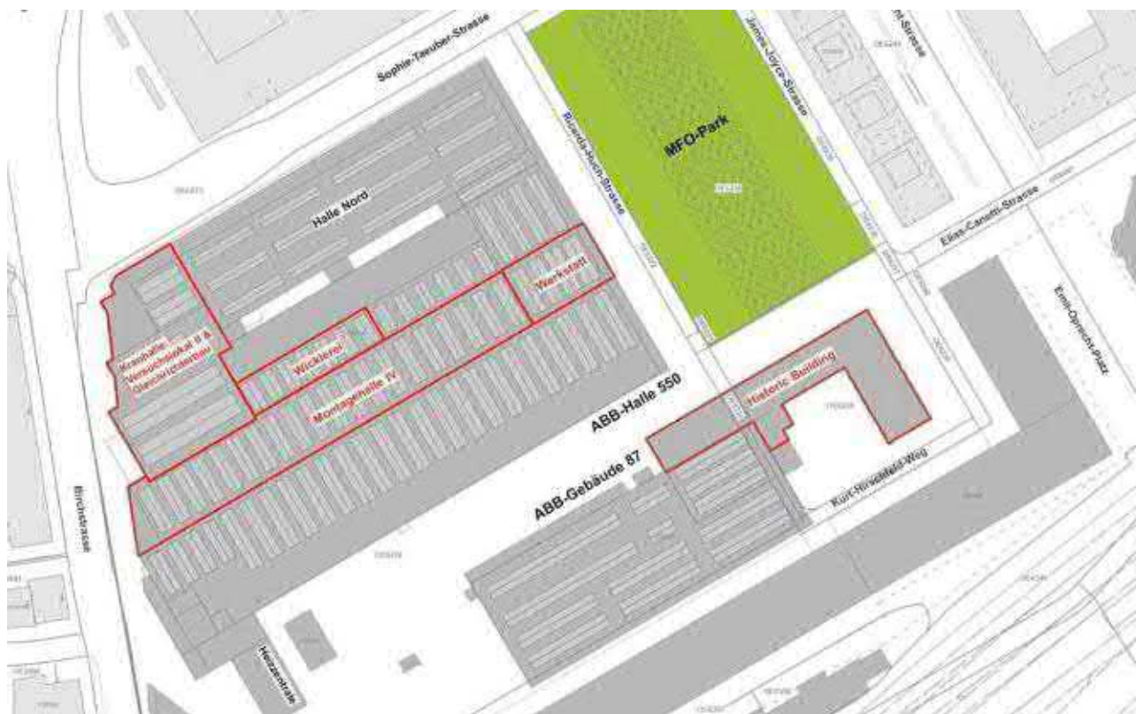
Abb. 7: Erhaltung von Teilen der Halle 550 und Gebäude 87T (Gebäudeteile rot umrahmt, Masterplan 10.07.2018)
