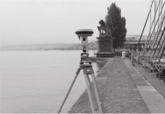
Satellitengestützte Vermessung mit GNSS-Station. (Bild: GeoZ)
